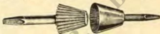
Фиг. 15. Конусообразный фрезер для труб.
