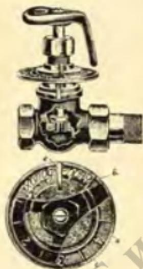
Фиг. 162. Регулировочный вентиль, ограниченный в своем движении и имеющий подвижной упор для изменения величины хода.
