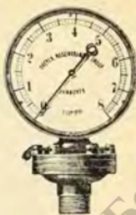
Фиг. 190. Манометр с пластичной пружиной.
