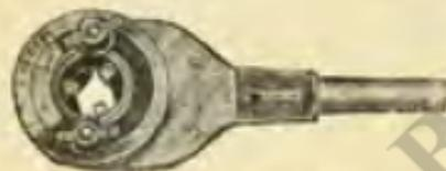
Фиг. 35. Одноручный газовый клупн (трещетка) с тремя переставными плашками.
