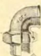
Фиг. 66. Отвод из ковкого чугуна с особой стяжкой муфтой.
