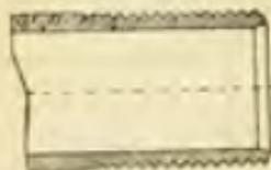
Фиг. 32. Цилиндрическая резьба с конически заканчивающимися витками, на трубе сваренной в стык (газовая труба).
