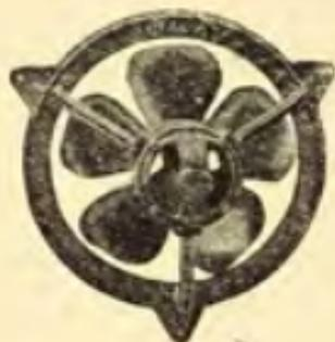
Фиг. 208. Винтовой вентилятор. Различная форма крыльев, обода, крестовины и непосредственное соединение с электромотором.
