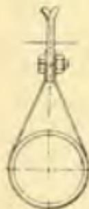
Фиг. 84. Подвеска труб с помощью обручного железа.
