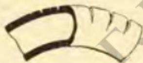
Фиг. 4. Газовая труба с диаметром  $\frac{1}{2}$ " с трещинами обнаружившимися на поверхности вследствие перегрева трубы. Рисунок пером с натуры.
