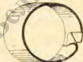
Фиг. 5.  $\frac{20}{26}$  мм патентованная труба плохой сварки. Рисунок по натуре. Угол отвернут монтером. На самой трубе не заметно дефекта.
