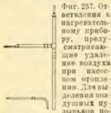
Фиг. 257. Ответвления к нагревательному прибору, предусматривающие удаление воздуха при насосном отоплении. Для выделения воздушных пузырьков подающему стояку.
