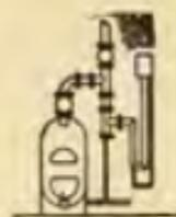
Фиг. 263. Паровой котел низкого давления с сушкой пара в трубопроводе непосредственно над котлом, благодаря внезапному изменению направления трубы. Стояк присоединен под паропроводом непосредственно над верхним уровнем воды; подающая линия дренирована.
