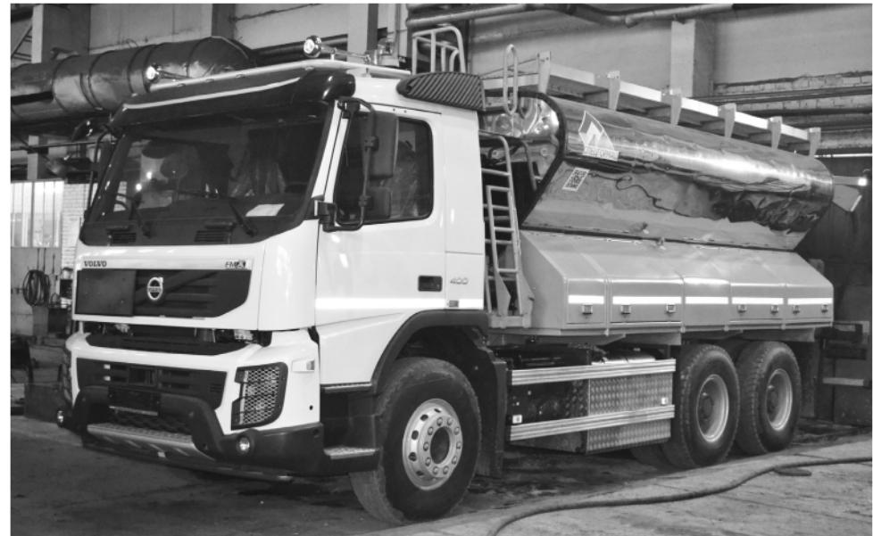
Готовая к эксплуатации новая взрывная машина на базе грузовика "Вольво".
