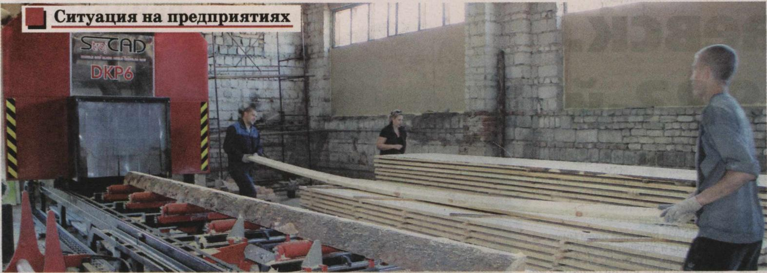
В работе лесопильный станок углового пиления
