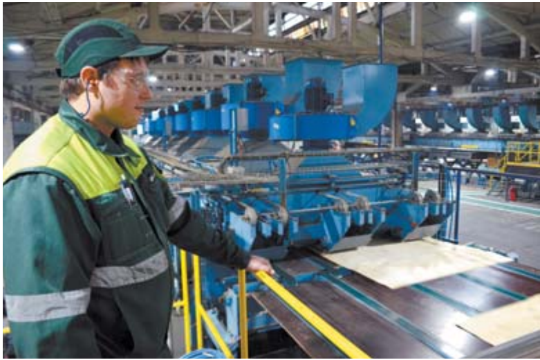
Процесс сушки шпона на новом оборудовании полностью автоматизирован
