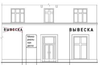
Перекрытие указателей наименований улиц и номеров домов (пункт 10.1 Правил).
