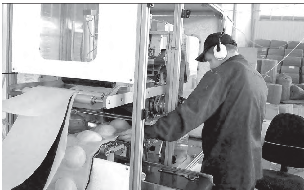
Производство респираторов на предприятии «Уралспецзащита» автоматизировано. Человек только контролирует процесс
