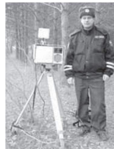
Передвижной комплекс «Радар КРИС-П» устанавливается, как правило, недалеко от края проезжей части
