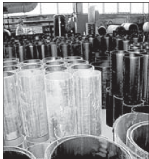
Полиэтиленовые трубы предназначены для подземной и надземной прокладки
