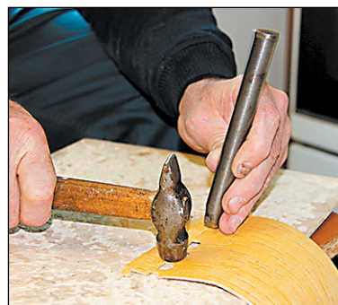
Инструменты берестяника – молоток и пробойник
