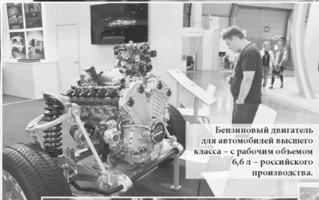
Бензиновый двигатель для автомобилей высшего класса – с рабочим объемом 6,6 л – российского производства.
