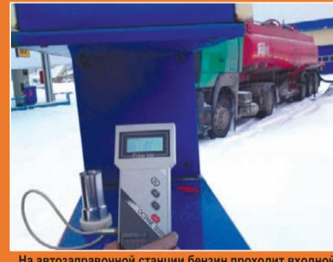
На автозаправочной станции бензин проходит входной контроль количества, плотности, замера октанового числа.
