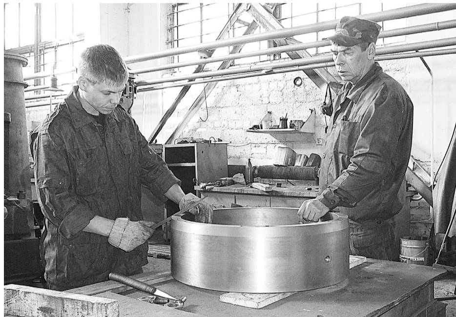
Обработкой стакана подшипника занимаются работники ОАО «УМЗ» Я.Ю. Степанов и В.Б. Ощепков.
