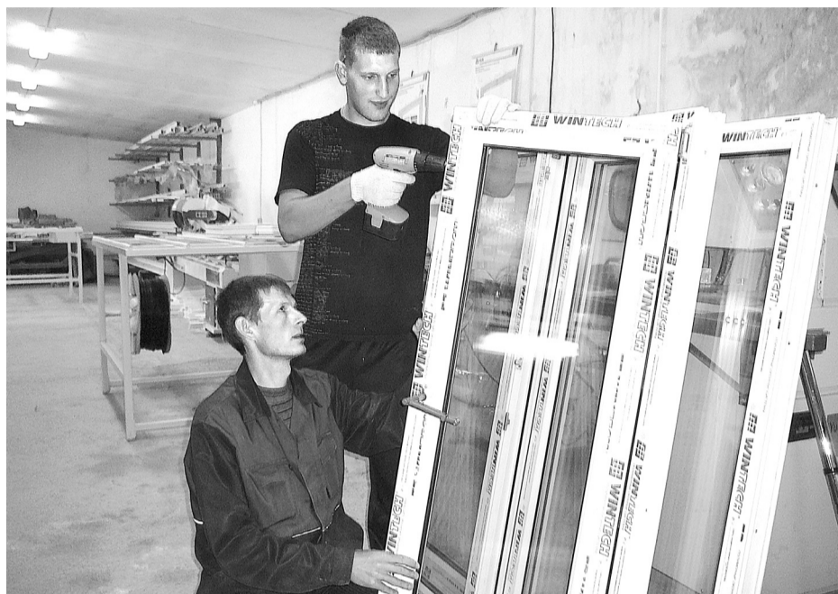
Сборкой оконных блоков из ПХВ занимаются работники ООО «Жилье» Е.В. Кузьмин и А.В. Бурмистров.
