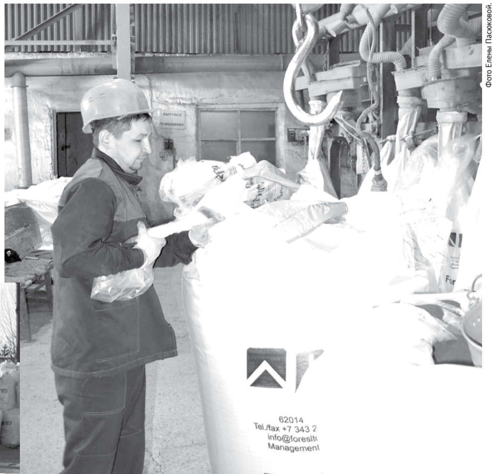
В одном из основных цехов завода – сортировочном – выполняется разделение гранул на фракции, упаковка и маркировка товара. На снимке: упаковкой занят просеивщик на механических ситах Иван Орлович.
