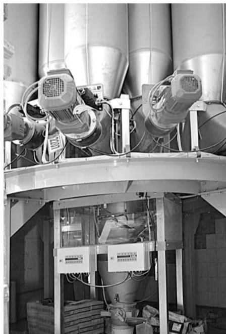
Движение сырьевых потоков направлено сверху вниз. На фото представлен модуль затаривания сырья.
