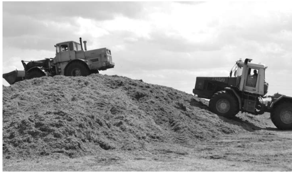
В сухую погоду в ООО «БМК» трамбовку зеленой массы трав ведут круглосуточно. Днем работают два мощных «Кировца».
