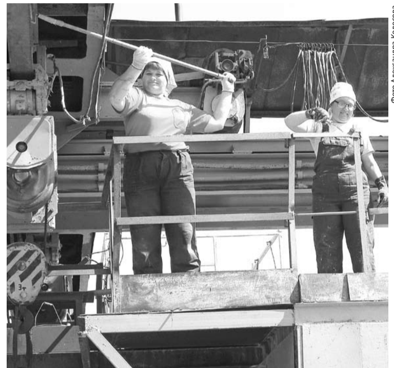
Маляры РСЦ Марина Коробицына и Наталья Сухогозува ведут покраску полукозлового крана на участке РМЦ.
