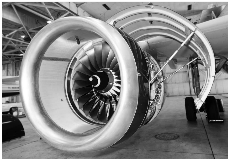
Кожух вентилятора, разработанный Goodrich для двигателя V2500-A5
