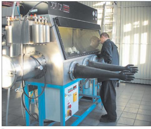
Газовый атомизатор HERMIGA 10/100 VI. Производство порошковых припоев и сплавов
