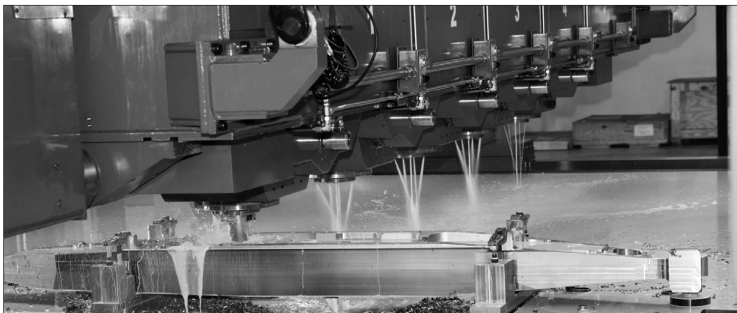
Со следующей недели на станке Cincinnati задействуют все пять шпинделей, благодаря чему будут обрабатываться по пять штамповок одновременно
