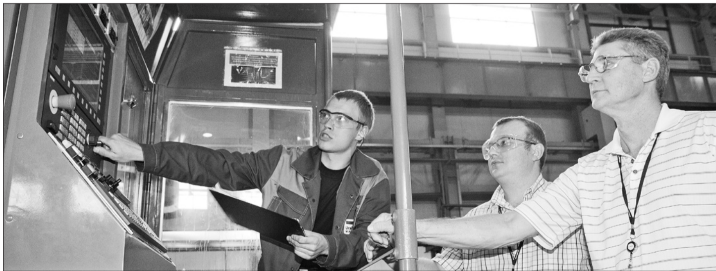
Идёт тестирование программы по механической обработке балки основной опоры шасси для Boeing 737
