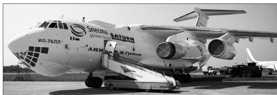
Лётная лаборатория Ил-76ЛЛ с двигателем SaM-146
