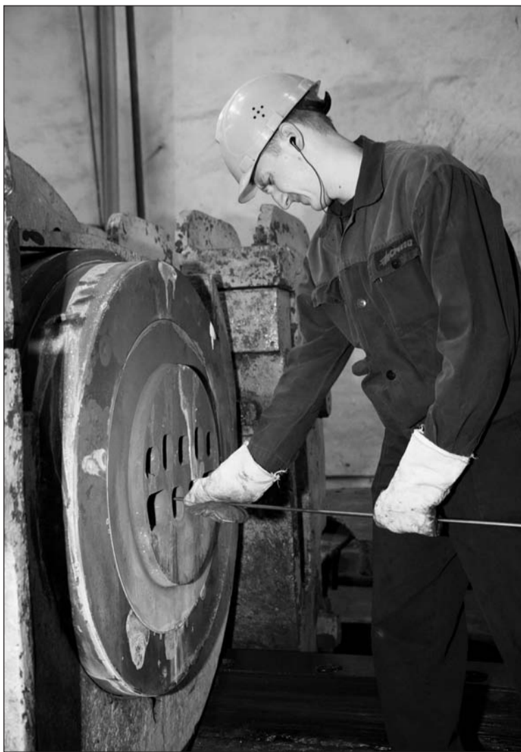
Обязательный замер температуры матрицы на соответствие требованиям технических условий
