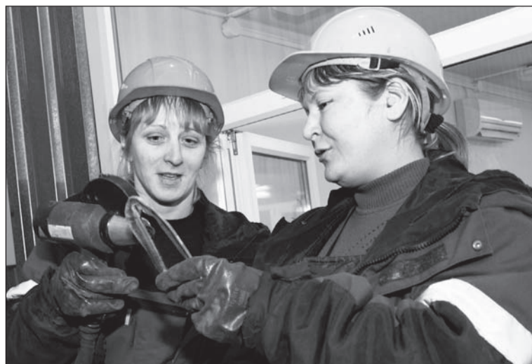
На участке сортировки цеха № 41 титановые отходы подвергаются стопроцентному контролю на соответствие маркам сплавов. На фото слева – контролёр Наталья Богданова и мастер Анатолий Магонин; справа – контролёры Тамара Боронина и Наталья Белова
