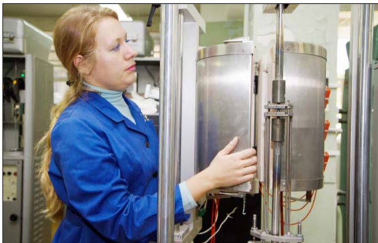
Инженер-лаборант Екатерина Таранова контролирует процесс испытания образца на ползучесть и длительную прочность
