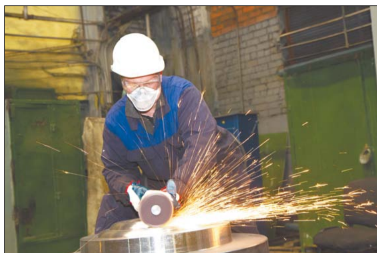
Обработка технологического инструмента абразивными кругами сухим способом
