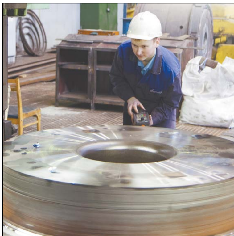
Токарь-карусельщик Евгений Кочуров занят обработкой штампа
