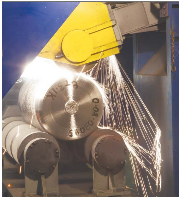
Новая зачистная машина удаляет дефекты со слитков быстрее и качественнее
