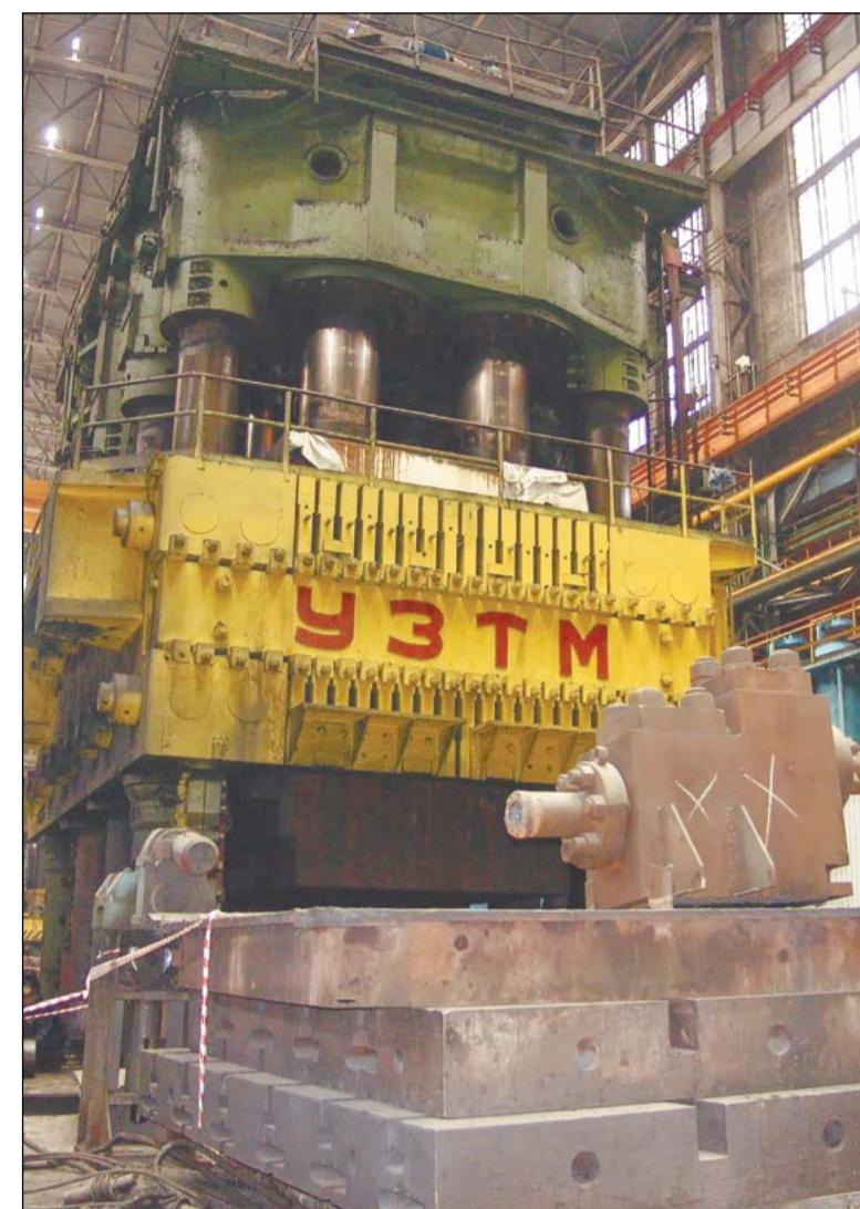
Огоньки сварки мелькают то с одной, то с другой стороны пресса-130. В кузнецном отделе цеха № 21 Корпорации ВСМПО-АВИСМА продолжается крупномасштабный ремонт и модернизация прессового агрегата. Вся территория вокруг него напоминает картину боевых действий, где на каждом участке выполняется определённая операция.
