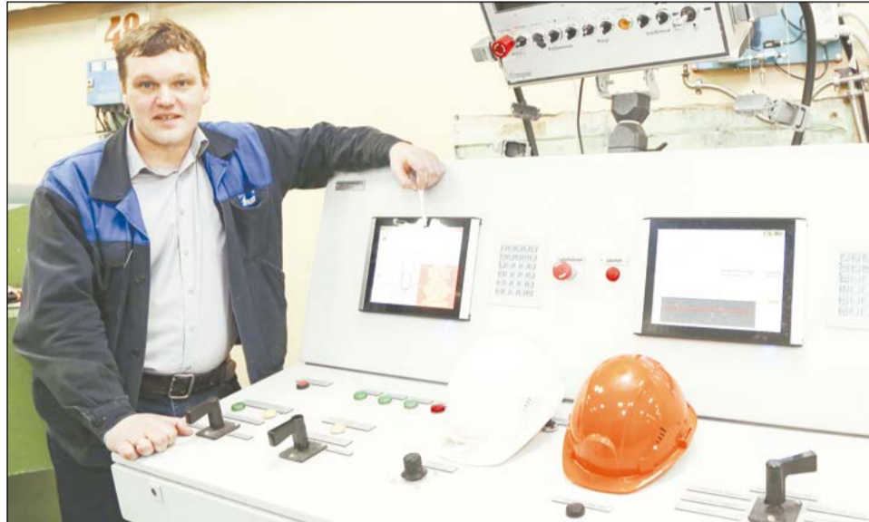
«Исключение перископов позволило установить на модернизируемую печь пульт фирмы Rittal», – поясняет Алексей Усов
