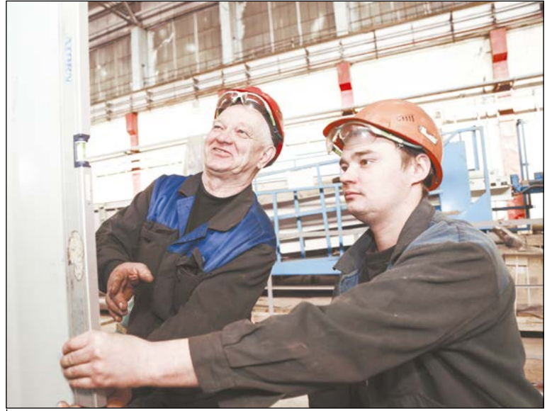
Слесари 50-го Вячеслав Шабаршин и Николай Левин выставляют по уровню стойку загрузочного устройства
