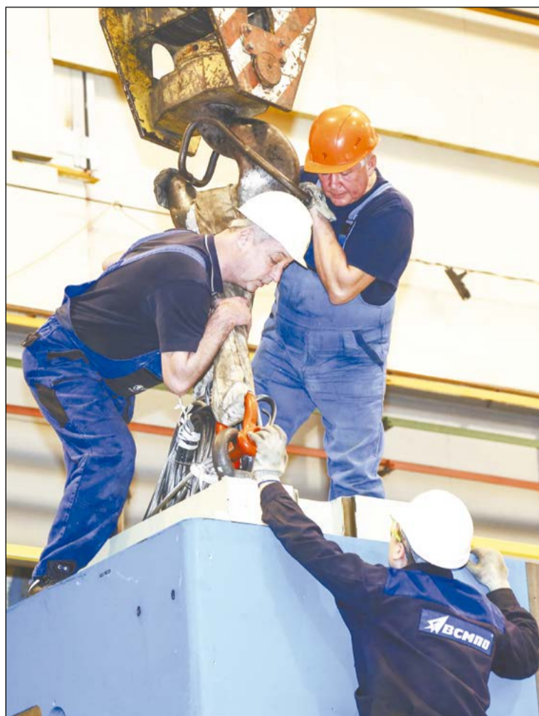
Благодаря высокой квалификации монтажников противовес точно входит в стойку станка
