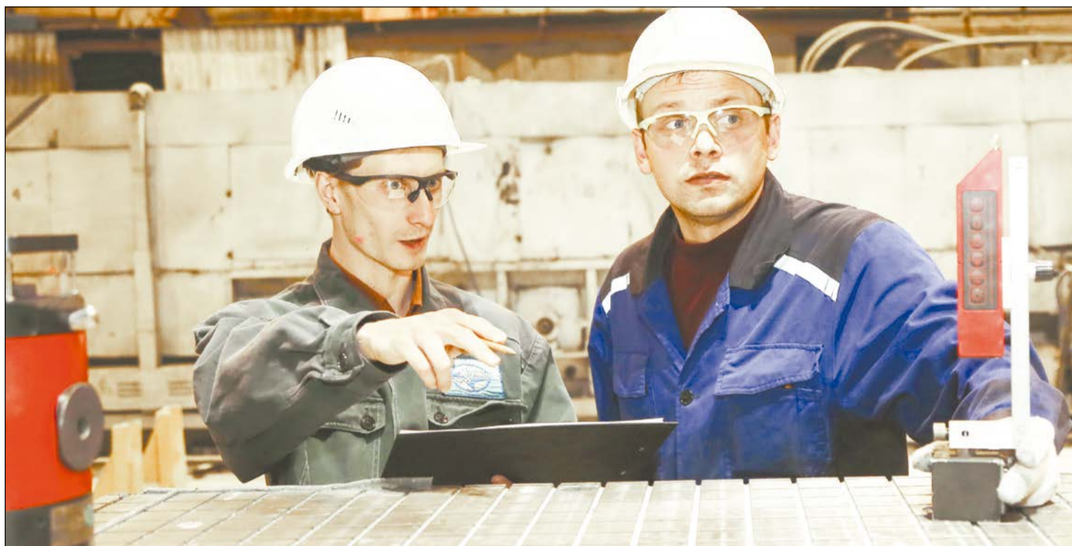
Денис Вдовин и Максим Моршинин проверяют плоскостность рабочих столов шлифовальных станков фирмы Timesavers в цехе № 16
