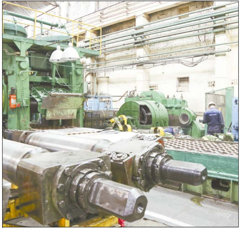
Двигатель, редуктор и станина клетки остались неизменными с 1939 года
