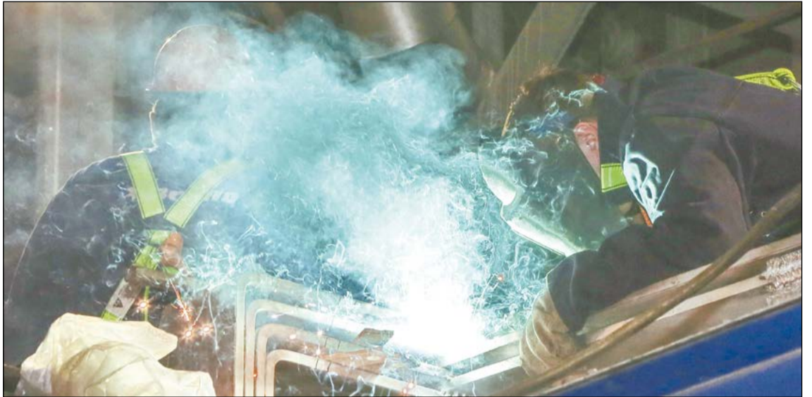
Вот так – в дыму и огненных брызгах создается очередной шинопровод
