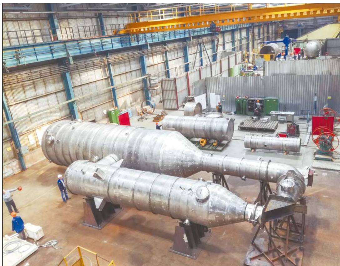
Титановая выпарная установка для калининградского соляного завода
