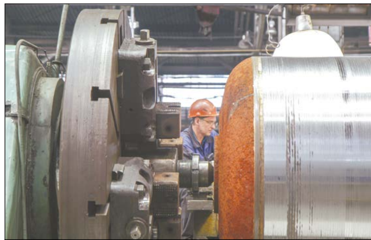
Ветеран – тяжёлый токарный станок – в ожидании замены продолжает обрабатывать плунжеры после наплавки
