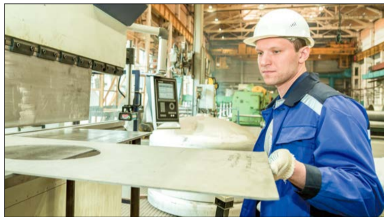
Инженер-технолог Роман Доронин подгибает заготовку на прессе
