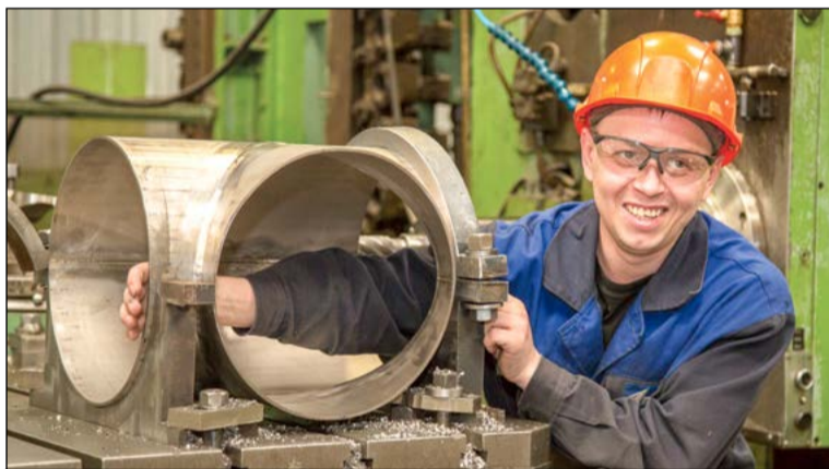
Станочник Вячеслав Коледенков выверяет установку заготовки для калибровки на расточном станке
