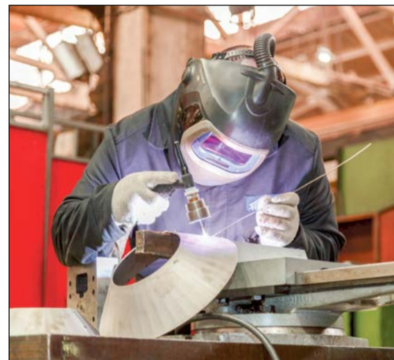
Евгений Мошков сваривает элементы будущего перехода
