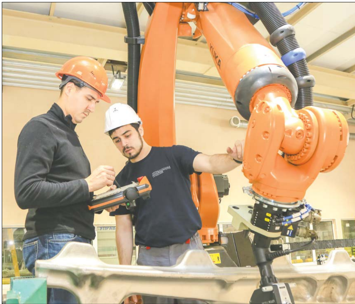
Инженеры Павел Ковин и Роберт Гафаров настраивают датчики робота
