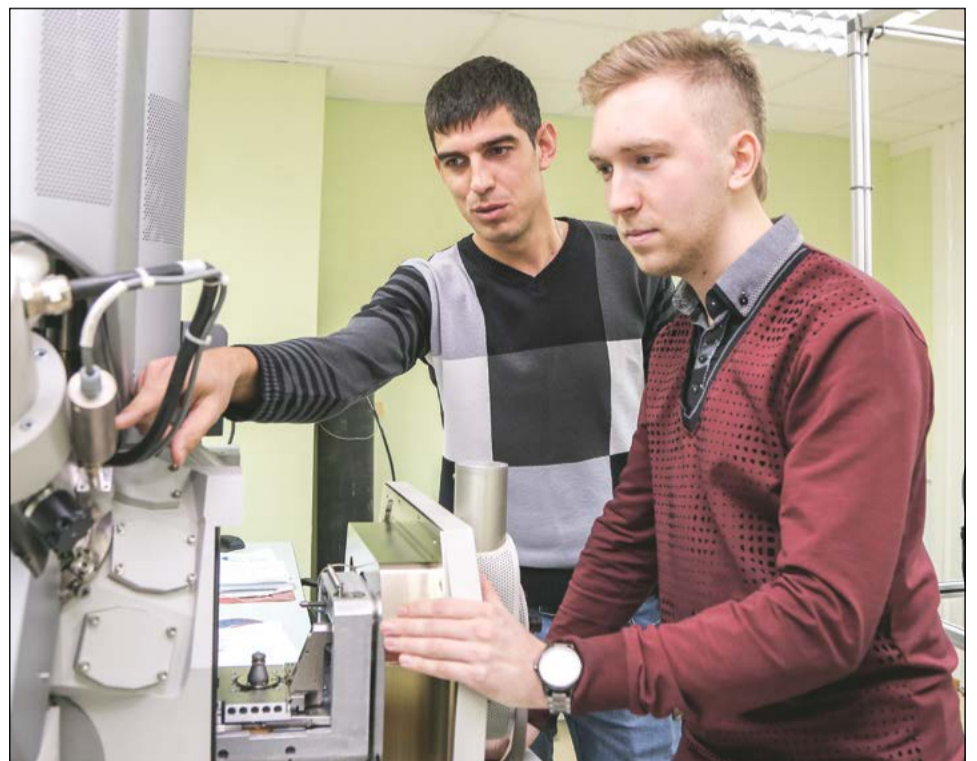
Анатолий Свяжин и Александр Гребеньчиков устанавливают образцы на растровый электронный микроскоп
