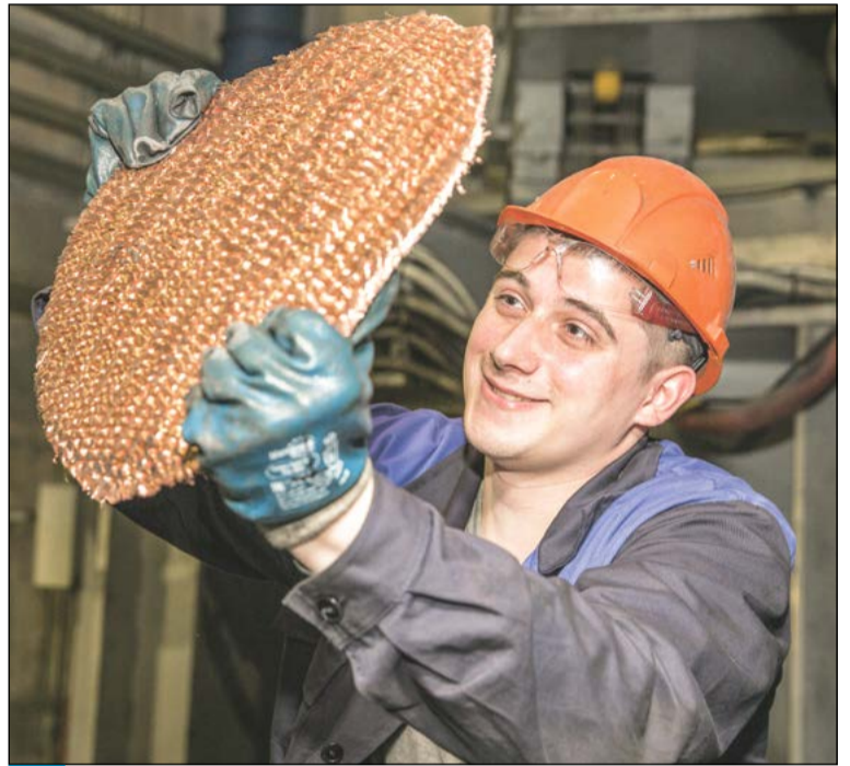
Плавильщик Артём Толмачёв готовит ковёр к очередной плавке в гарнисажной печи
