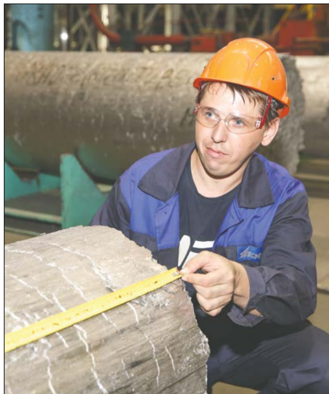
Иван Сосновских, прессовщик, уточняет размеры электрода
