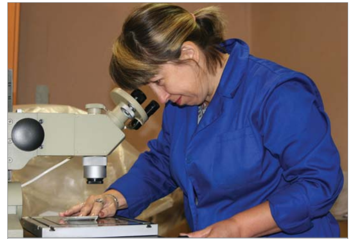
Техник-метролог Марина Николаевна Шафигуллина проверяет сито под микроскопом.
