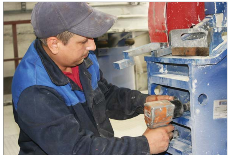
Слесарь Василий Киселько меняет бронь на щёковой дробилке.
