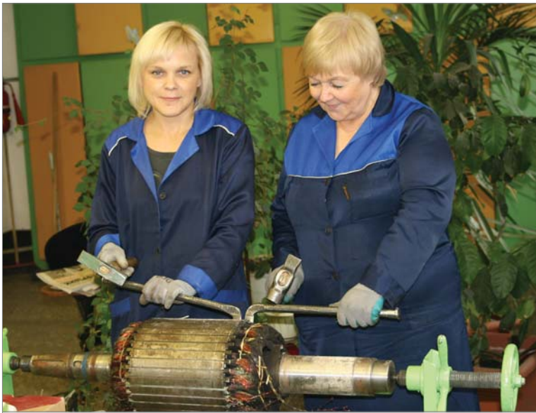
Вера Панова и Юлия Фисюк выстукивают обмотку из ротора.
