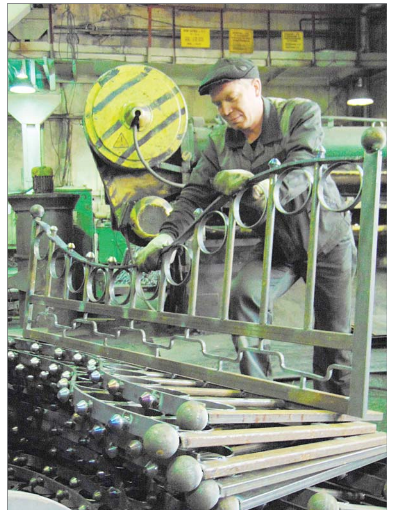
Слесарь-сборщик металлоконструкций Евгений Сарапулов: «Готова очередная секция будущего ограждения».
