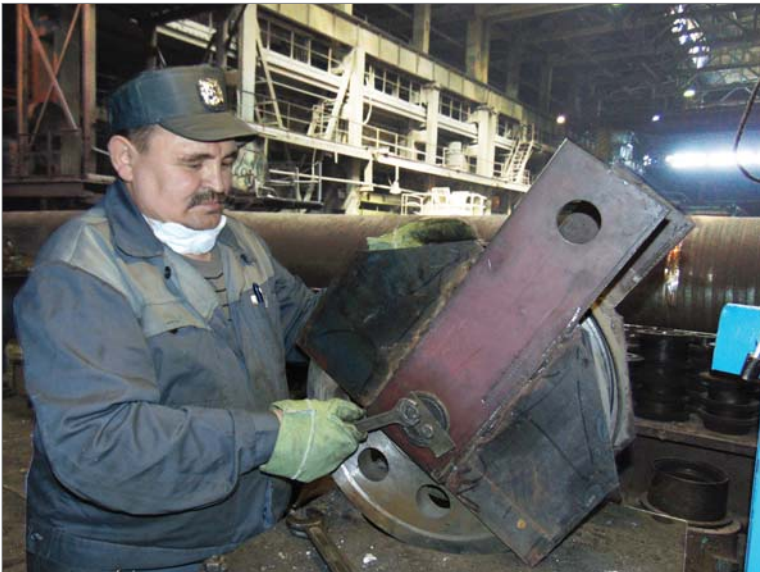
Слесарь-ремонтник Ильшат Галимов ремонтирует крюковую подвеску.
