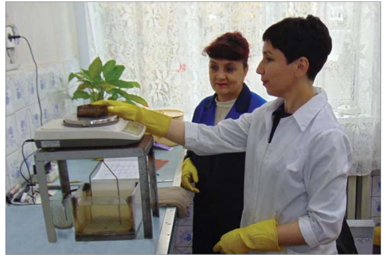
Под руководством лаборанта Аллы Мордвиновой взвешиваю зерно кварцита на гидростатических весах.
