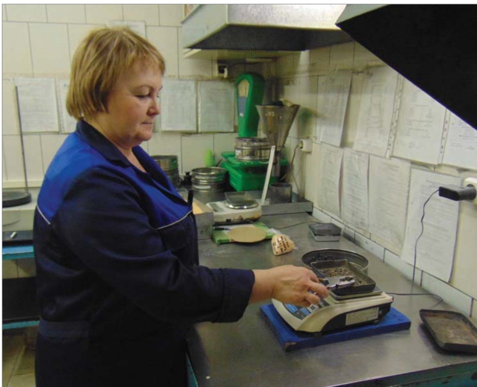
Валентина Шеина определяет влажность желобной массы.
