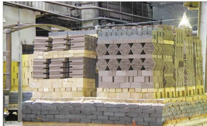
Очередная партия огнеупорной продукции готова к прогонке в туннельной печи №4.
