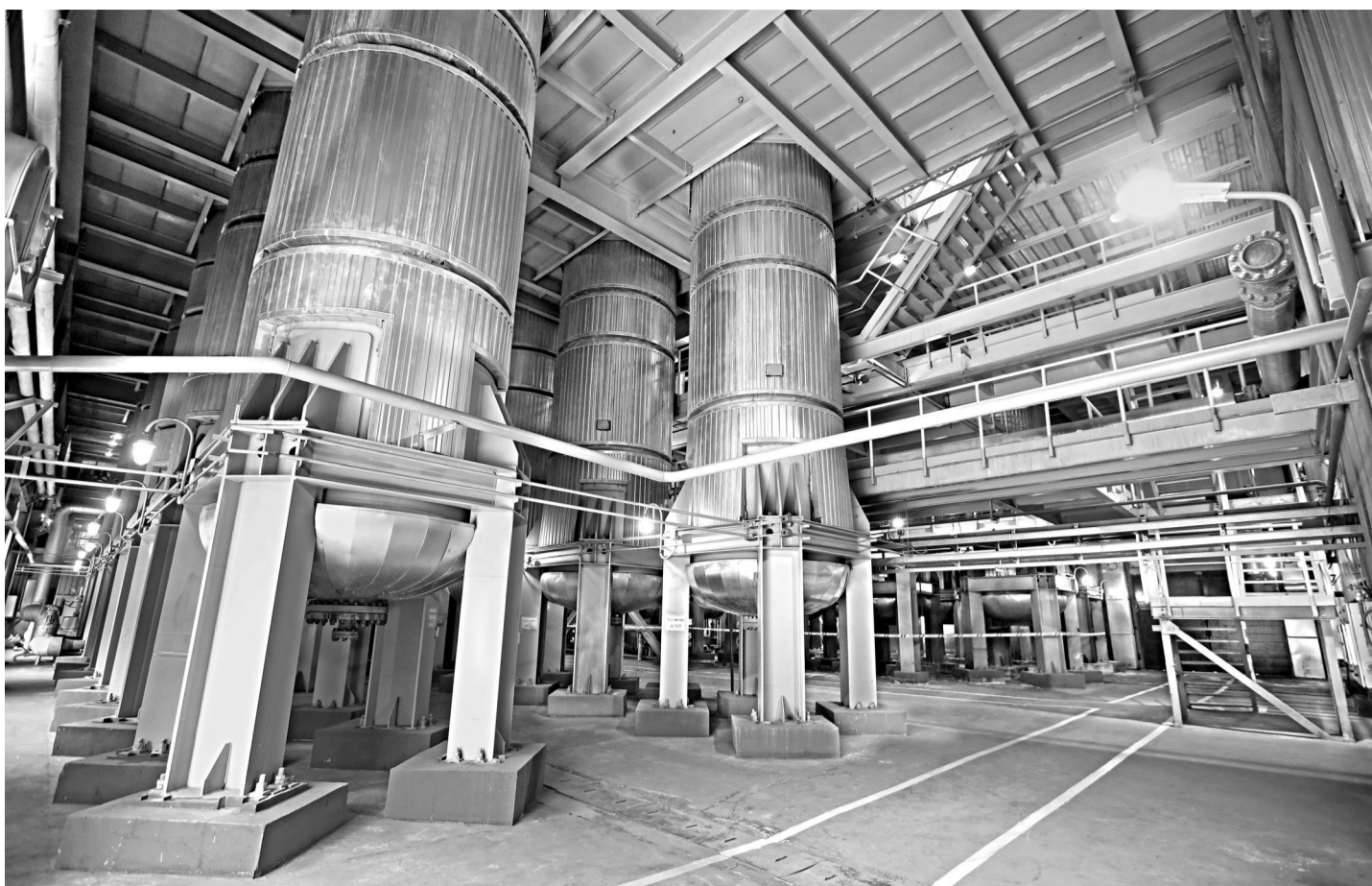
На алюминиевом заводе в Каменске-Уральском завершена масштабная модернизация глиноземного производства. Предприятию почти 80 лет. Замена устаревшего оборудования на современное и внедрение энергоэффективных технологий стали необходимостью. Компания инвестировала в проект 1,5 миллиарда рублей. На днях завершился последний этап — установка автоклава батарей (на снимке). Сегодня выщелачивание боксита — это безлюдное автоматизированное производство. Модернизация позволит заводу увеличить выпуск глинозема на 17 процентов, или на 130 тысяч тонн в год.
