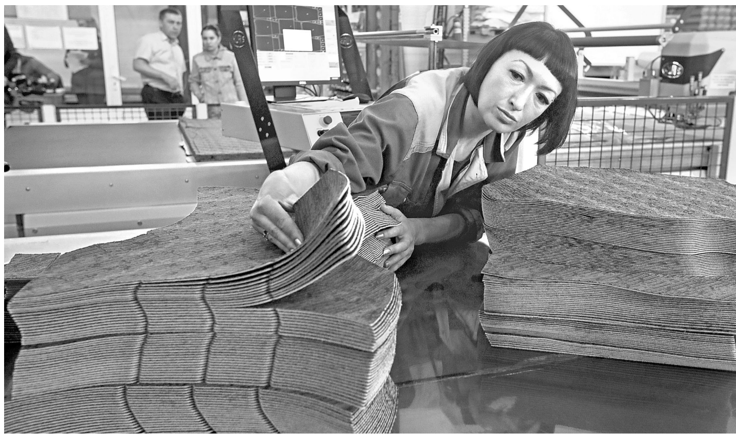
В Свердловской области запущена новая линия по выпуску комплектующих для транспорта — введен в эксплуатацию раскройный комплекс для изготовления сидений. Оборудование позволит увеличить производительность в несколько раз и выкраивать до 150 тысяч чехлов в месяц. Одним из источников финансирования проекта стало выделение льготного займа Фондом развития промышленности. По словам директора компании Дмитрия Камерлохера, бизнес успешно развивается во многом благодаря поддержке государства. Сейчас предприятие работает со 125 отечественными и зарубежными потребителями и намерено расширить их список и линейку выпускаемой продукции.
