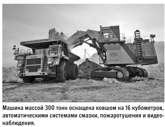
Машина массой 300 тонн оснащена ковшем на 16 кубометров, автоматическими системами смазки, пожаротушения и видеонаблюдения.
