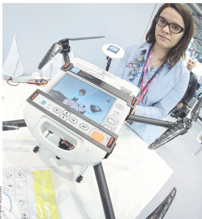
Дрон-дефибриллятор проанализирует ЭКГ, сохранит данные для врача и при необходимости произведет серию разрядов.
